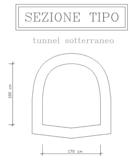
Figura 7 – Sezione tipo rio Ronzone nel tratto sito al di sotto dello stabilimento.
