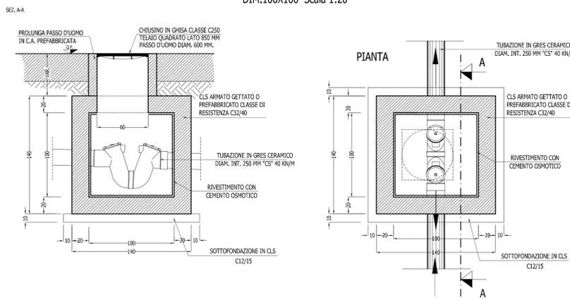
POZZETTO DI ISPEZIONE PREFABBRICATO DIM.100X100 Scala 1:20
