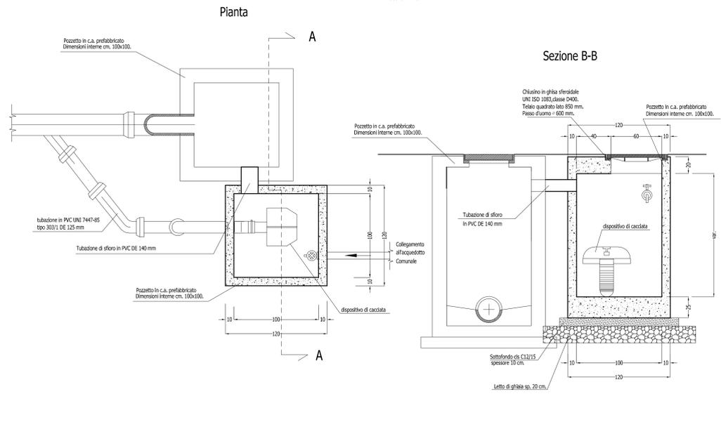
POZZETTO DI ISPEZIONE SIFONATO DIM.100X100 Scala 1:20
